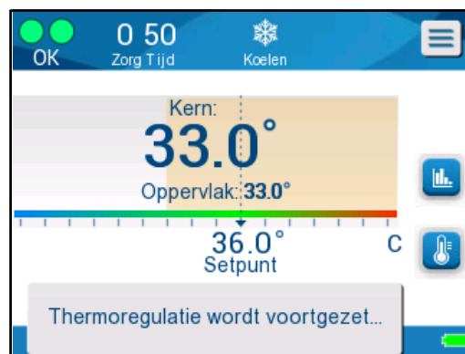
Figuur 33: Melding thermoregulatie wordt voortgezet
