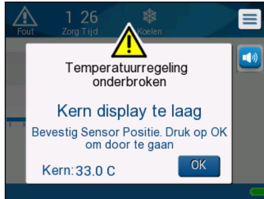
Figuur 32: Melding temperatuurregeling onderbroken - kern display te laag
