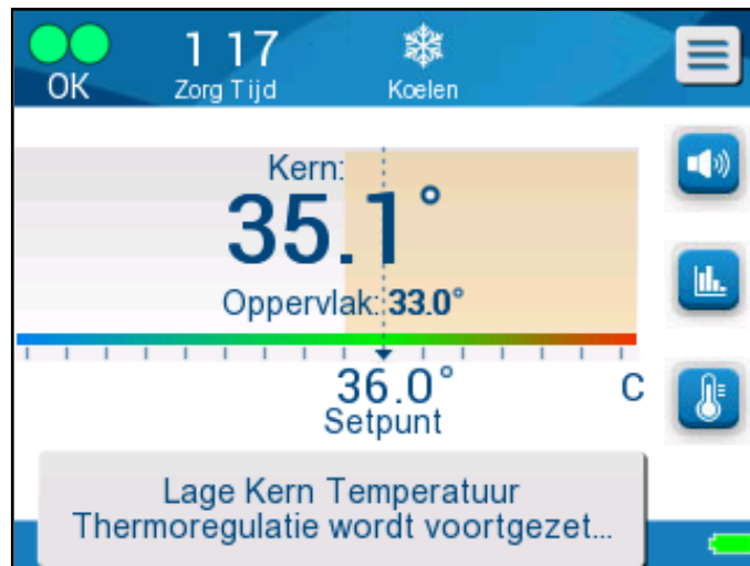
Figuur 31: Alarm lage kerntemperatuur
