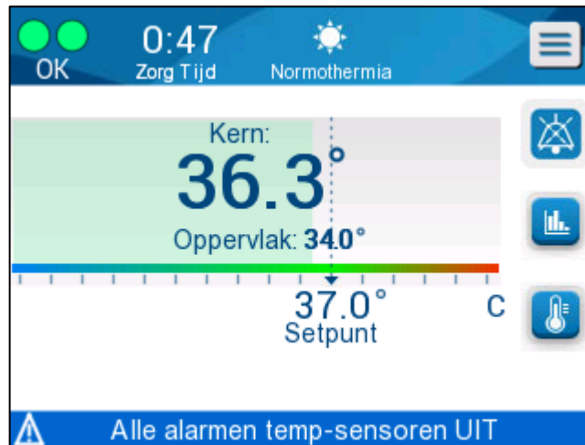
Figuur 25: Alle temperatuursensoren Alarm uit-indicator
